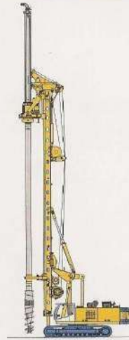
FDP Verdrängerbohren Full Displacement Piling
